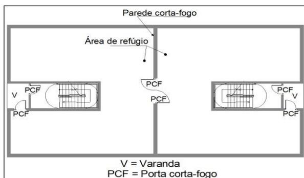
**Figura 25:** Desenho esquemático da área de refúgio
