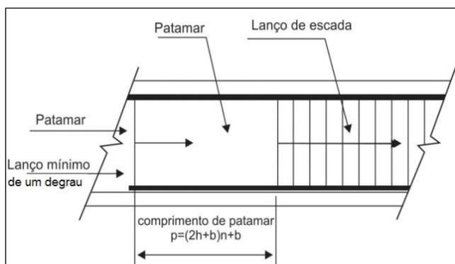
Figura 5: Lanço mínimo e comprimento de patamar
