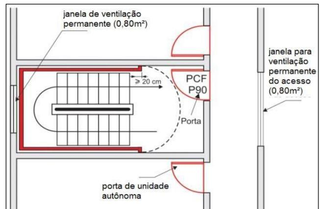
**Figura 15:** Ventilação da escada enclausurada protegida e seu acesso
