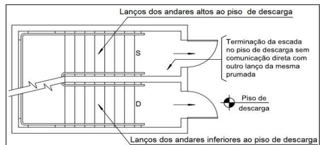
Figura 3: Segmentação das escadas no piso da descarga
