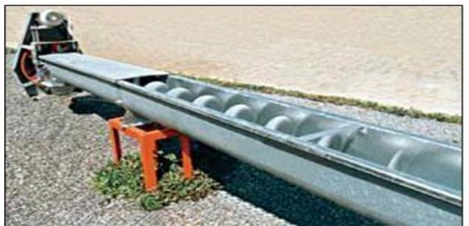
Figura 6: Transportador helicoidal
