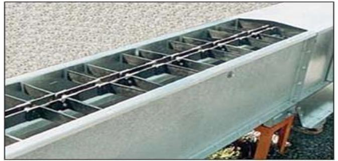
Figura 4: Transportador de corrente
