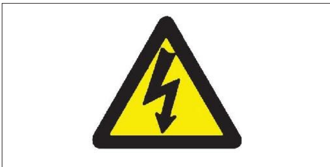
Figura 1: Sinalização de quadros elétricos
