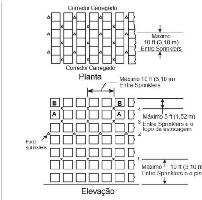
**Figura 5.3.4.4.1(b):** Distribuição de chuveiros internos - estruturas porta-paletes múltiplas, mercadorias Classe I, Classe II ou Classe III, altura de armazenagem acima de 7,6 m (25 ft)
