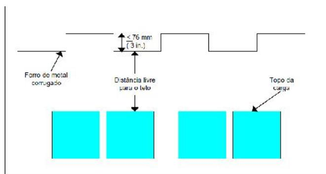
Figura E.2: Forro de metal corrugado com profundidade  $\le 76$  mm.
