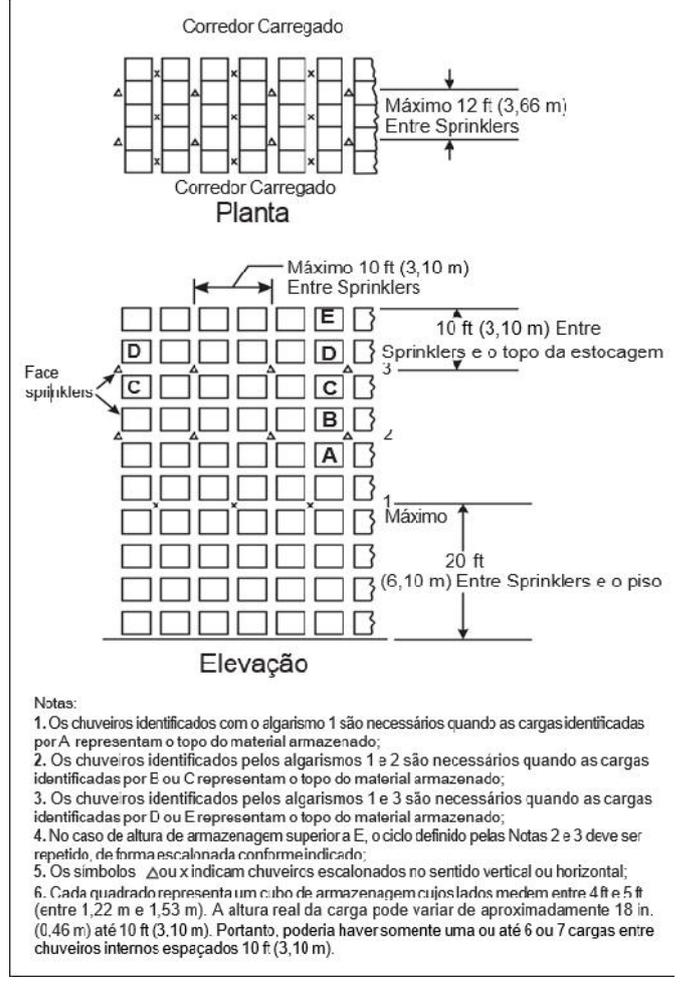
**Figura 5.3.4.4.1(a):** Distribuição de chuveiros internos, estruturas porta-paletes múltiplas, mercadorias Classe I, altura de armazenagem acima de 7,6 m (25 ft)
