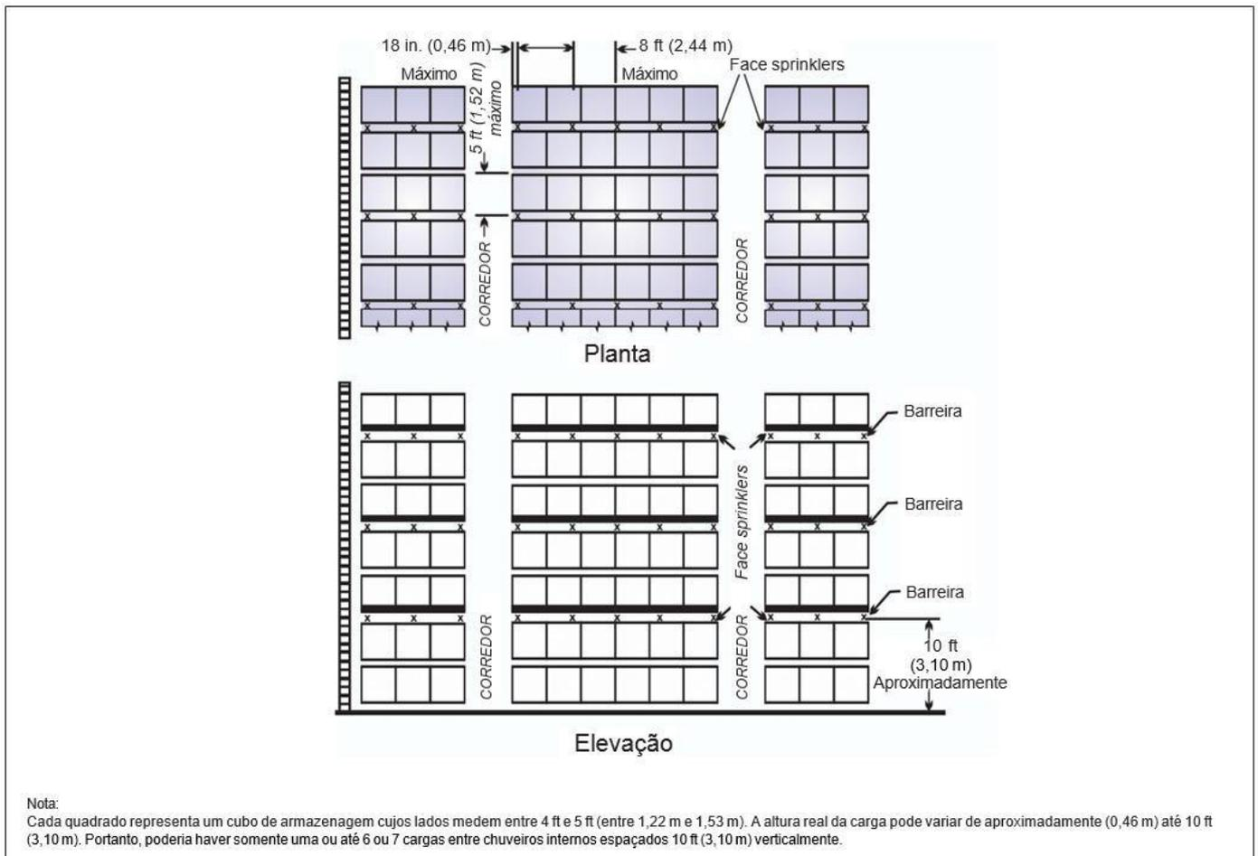
**Figura 5.3.5.4.1.3(b):** Distribuição de chuveiros internos, plásticos em caixas de papelão e plásticos não expandidos expostos, estruturas porta-paletes múltiplas, altura de armazenagem acima de 7,6 m (25 ft) - **Opção 2** [(Espaçamento máximo de 3,10 (10 ft)].
