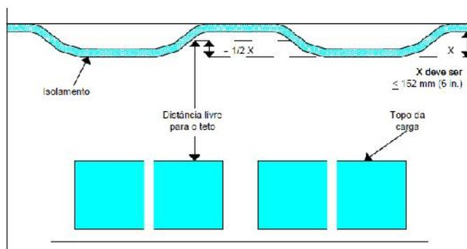
Figura E.5: Forro com isolamento que desvia ou envergua para baixo da estrutura do teto no teto (caso 1)
