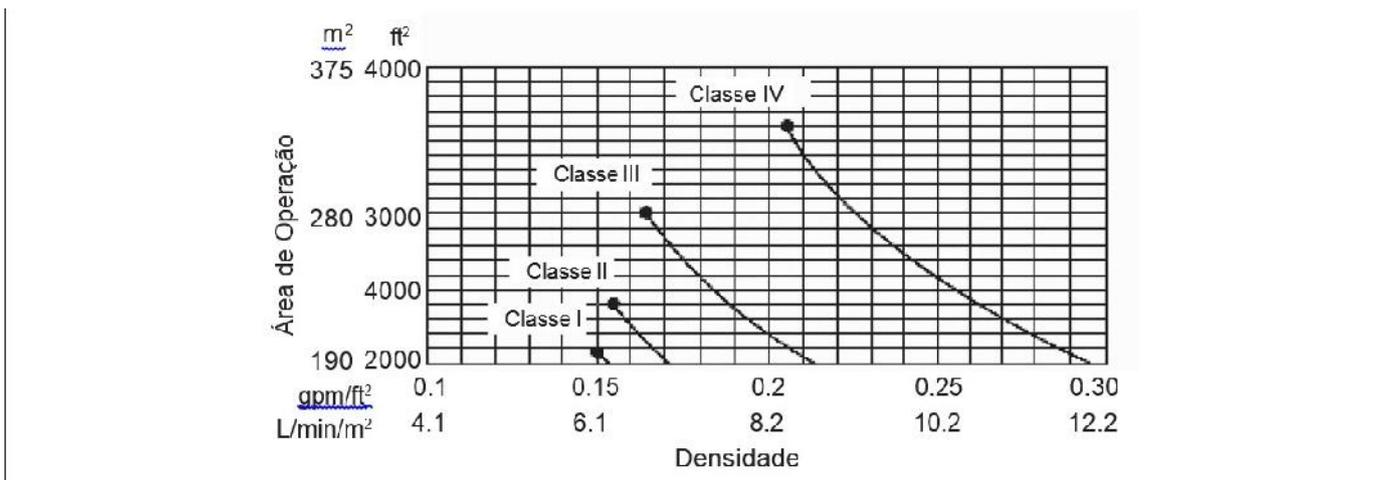
Figura 5.2.2.1.5.2: Curvas de projetos de sistemas de chuueiros, armazenagem a 6,1 m (20 ft) de altura - chuueiros de temperatura alta.
