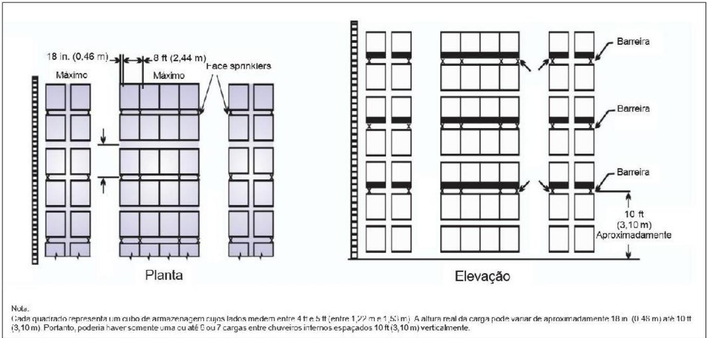
**Figura 5.3.5.4.1.3(a):** Distribuição de chuveiros internos, plásticos em caixas de papelão e plásticos não expandidos expostos, estruturas porta-paletes múltiplas, altura de armazenagem acima de 7,6 m (25 ft) - **Opção 1** [Espaçamento máximo de 3,10 (10 ft)]
