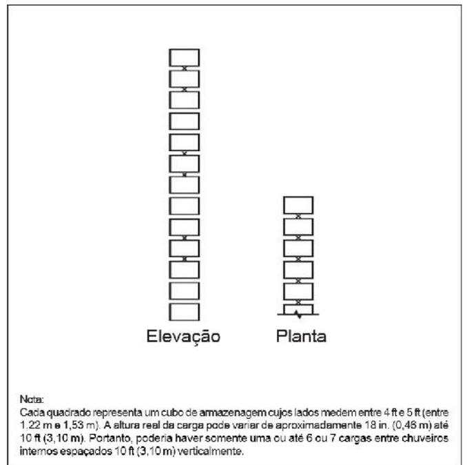
**Figura 5.3.4.4.1.2(a):** Distribuição de chuveiros internos, mercadorias Classe I, Classe II, Classe III ou Classe IV, estruturas porta-paletes simples, altura de armazenagem acima de 7,6 m (25 ft) - **Opção 1.**
