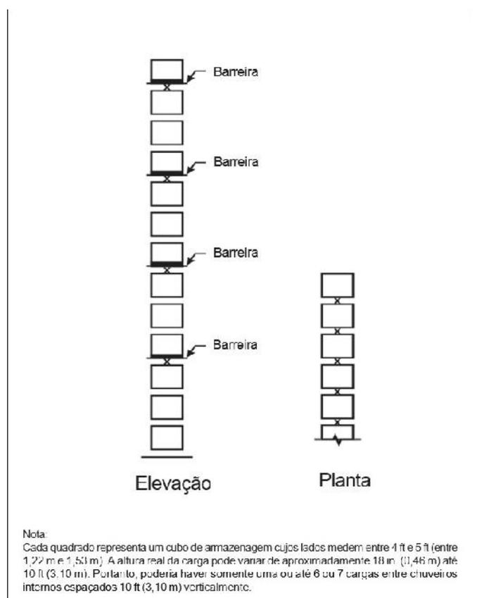
**Figura 5.3.4.4.1.2(d):** Distribuição de chuveiros internos, mercadorias Classe I, Classe II, Classe III ou Classe IV, estruturas porta-paletes simples, altura de armazenagem acima de 7,6 m (25 ft) - **Opção 2.**
