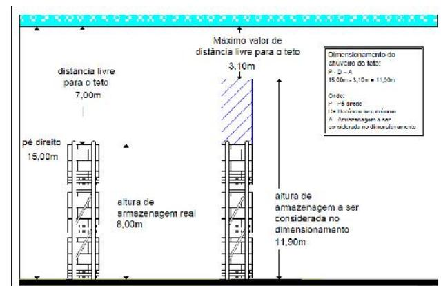
Figura E.7: Exemplo (B) tabela E.1: Máxima distância do topo do armazenamento para o teto para os critérios de proteção do Chuveiros de controle área/densidade (CCAD)
