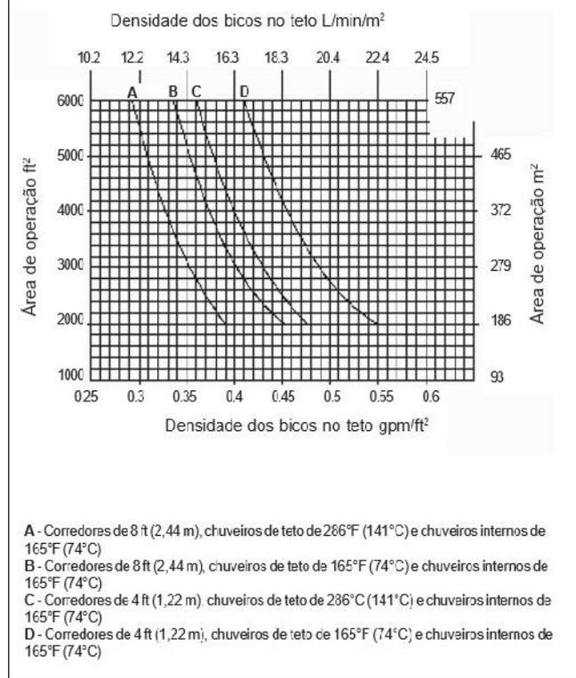
**Figura 5.3.2.1.2(g):** Estruturas porta-paletes simples ou duplas - Armazenagem a 6,1 m (20 ft) de altura em estruturas porta-paletes - Curvas de projeto de sistemas de chuveiros - Mercadoria Classe IV encapsulada - Paletes convencionais.
