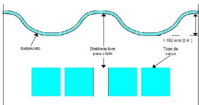
Figura E.6: Forro com isolamento que desvia ou envergua para baixo da estrutura do teto no teto (caso 2)
