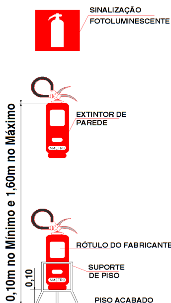
Figura 1: Fixação de extintor de incêndio
